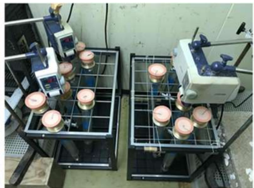
図3 底質コアの採取および溶出実験の様子
