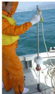
図3 底質コアの採取および溶出実験の様子
